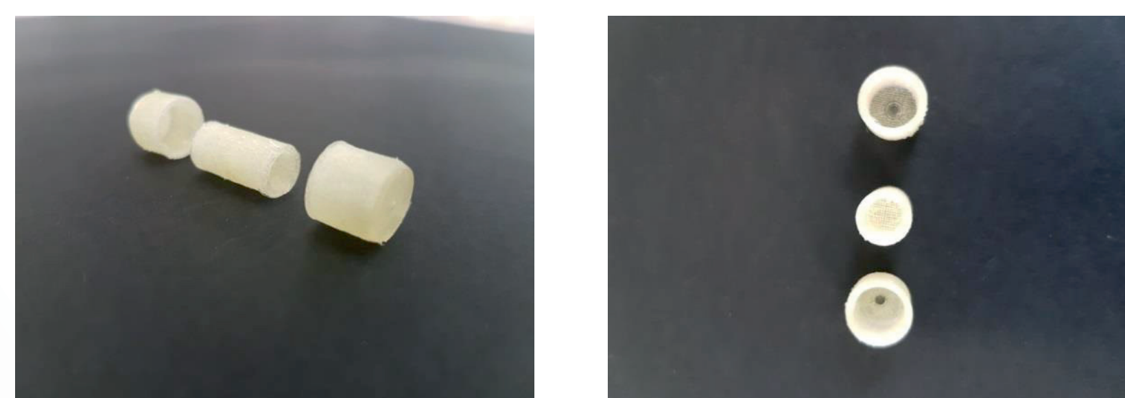
Slika 3. Tiskani model Super-H; a) dva poklopca i baza b) unutrašnjost
